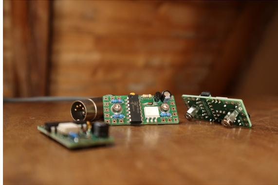
Der **Goblin-SPST** ist eine Variante für Effektgeräte mit Soft Switches (digital, oder relaisbasiert). Für Effektgeräte mit True Bypass Schaltungen die einen herkömmlichen 3PDT-Schalter verwenden gibt es den etwas größeren **Goblin-3PDT**.
